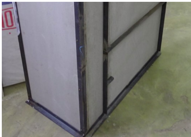
Foto 9 – Montagem dos painéis no quadro de cantoneiras. Vista posterior.
