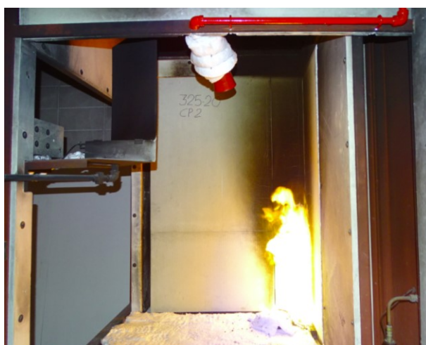
Foto 13 – Realização do ensaio de reação ao fogo.
