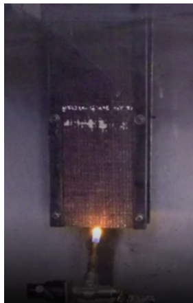
Foto 5 – Ensaio com o queimador aplicado na borda do corpo de prova.
