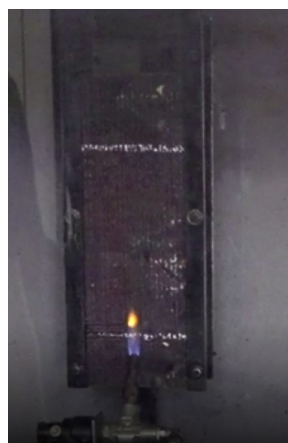
Foto 8 – Chama não atinge a marca de 150 mm.
