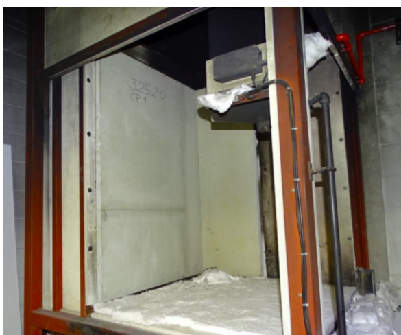
Foto 12 – Disposição do material no carrinho do equipamento de ensaio.
